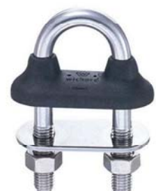
Wichard U-Bolt 316SS 8mm 2400kg WL 4800kg BS* 10mm 3600kg WL 7000 BS* p/n 65351
